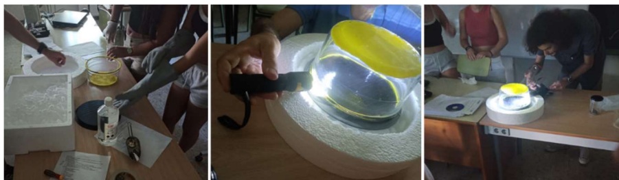
Figura 1. Fotografías de: los materiales empleados por las alumnas en la construcción de su cámara de niebla (izquierda), la cámara de niebla montada (centro) y uno de los autores aproximando el tubo de rayos catódicos a la cámara (derecha).
